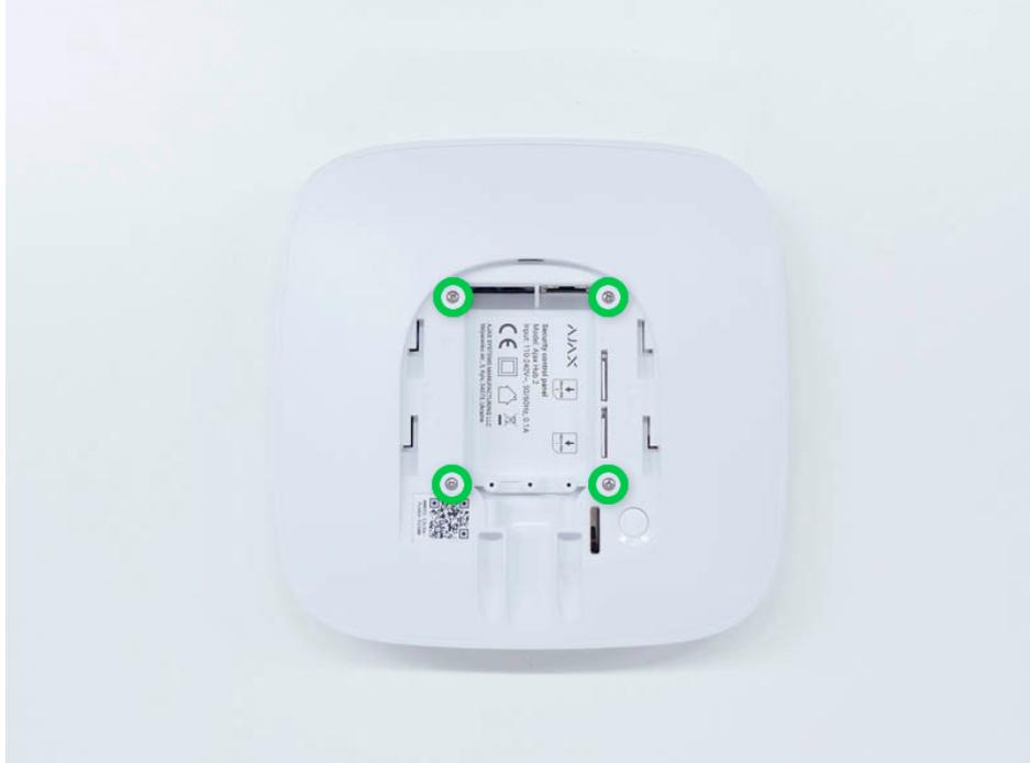
5. Rimuovere le viti che fissano le schede al corpo del dispositivo.
